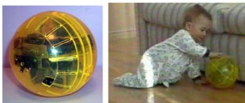
**Fig. 11** Roball [30], prototipo de robot de juguete diseñado en 1998 en la Universidad de Sherbrook (Québec, Canadá) que interacciona con bebés que aún no tienen capacidad de hablar mediante movimientos, velocidades y música. Su diseño esférico le permite movimientos y protección contra choques que con otra forma no serían posibles.
