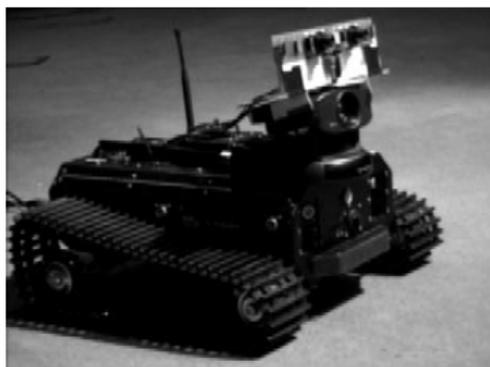
**Fig. 13** Robot propuesto por R. Tanawongsuwan [34] con una cámara PTZ y un sistema estéreo SRI
