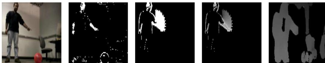
**Fig. 14** Tracking de personas mediante una cámara montada sobre un robot. Las personas realizan un gesto a modo de orden para que el robot traiga una pelota. De izquierda a derecha: a) Imagen original, b) Segmentación con el color de piel, c) Imagen binaria de energía en función del movimiento, d) MHI (Imagen Histórico de Movimiento) Muestra la dirección del movimiento, e) imagen estéreo
