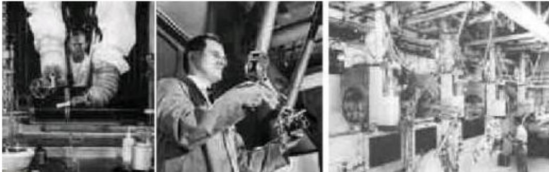
*Figura 1.5: Telemanipuladores de Goertz. Argonne National Laboratory (1948)*
