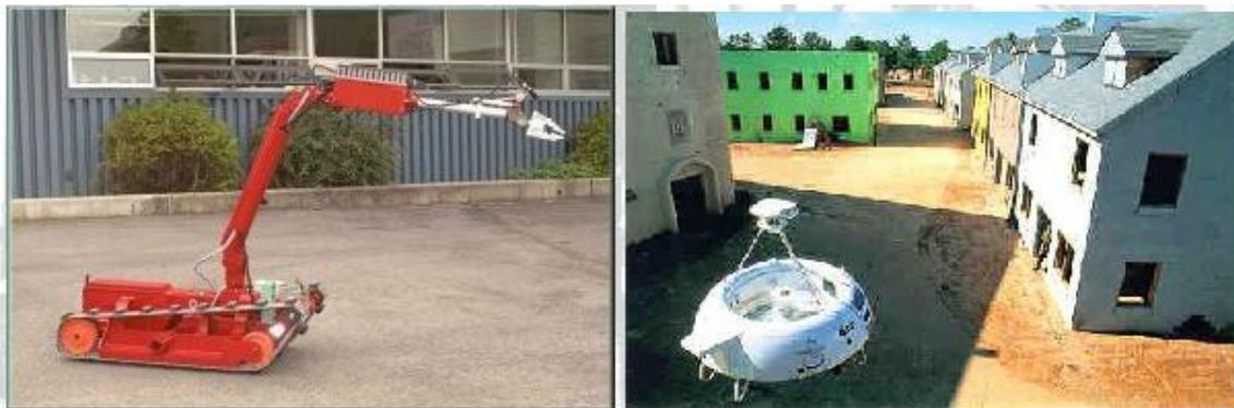
Figura 1.8: Robots Militares: 'MERV' Desactivador de bombas remoto (izquierda). 'Cypher' helicóptero militar de control remoto (derecha)
