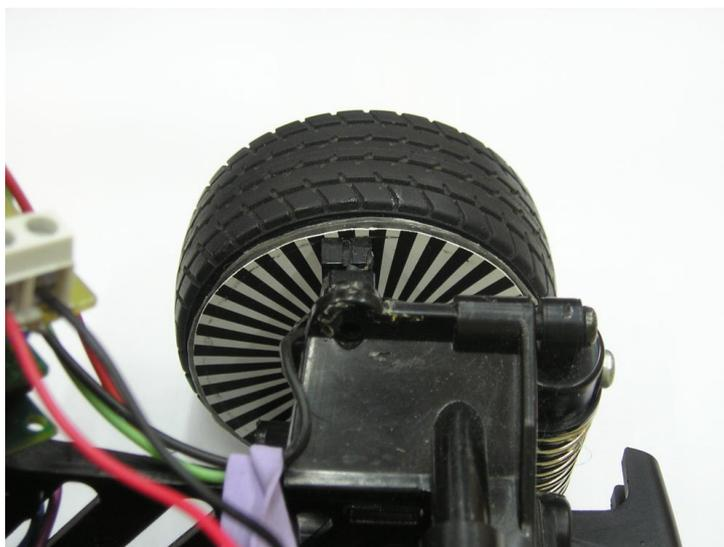
Figura 3.5: Encoder artesanal montado en una de las ruedas
