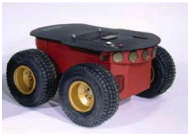
Figura 3.1: El robot Higgs. Un robot móvil Pioneer 2-AT8 de ActivMedia Robotics.
