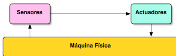
Figura 4: El sistema de control retroalimentado más elemental está compuesto por un sensor y un actuador gobernado por los valores del sensor. Es el caso del frigorífico, en el que el sensor de temperatura —usualmente un bimetálico— conecta y desconecta el compresor.
