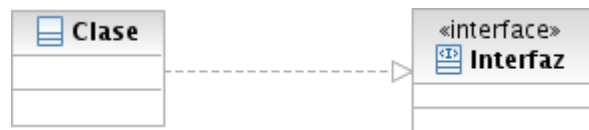
Figura 2.9 Representación de interfaz y realización en UML
