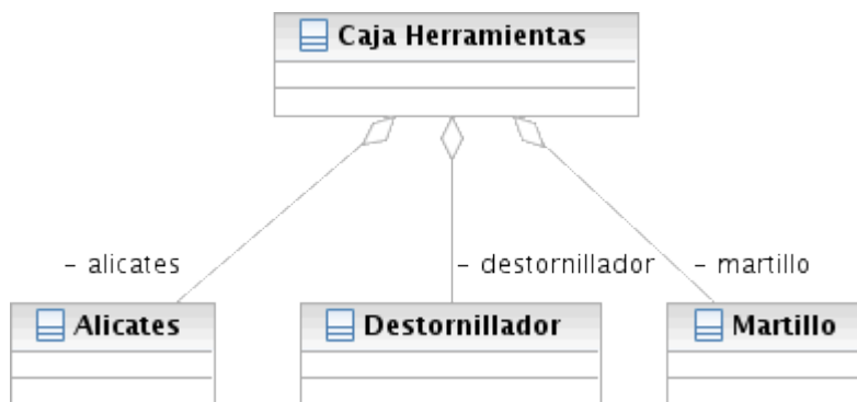
Figura 2.7 Representación de una agregación en UML
