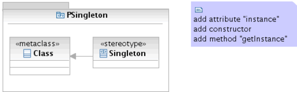
Figura 2.16 Perfil y transformaciones generadas
